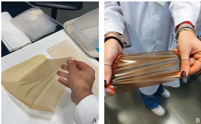
Figura 1 a, b. Esempio di biopackaging attivo sviluppato con un blend polimerico costituito da farina di semi di carrube e k-carragenina con l'aggiunta di glicerolo in funzione di plastificante e attivato con estratto acquoso della buccia del melograno rosso (sinistra) e melograno nero (destra).
