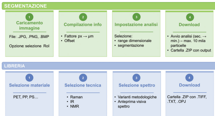
Figura 4. Schema illustrativo dell'interazione dell'utente con i due moduli principali del servizio Microplastics Analyzer . Nella parte superiore è rappresentato il flusso operativo relativo all'analisi di dimensione e forma di microplastiche da immagini acquisite tramite microscopia ottica, mentre nella parte inferiore è riportato il modulo dedicato alla consultazione e al download della libreria di spettri dei polimeri.
