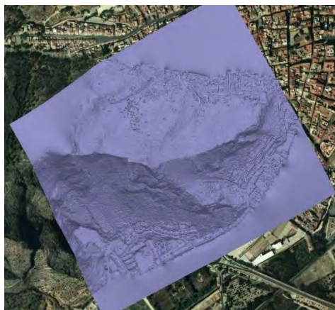
Fig. 10- Vista de la malla sin textura generada en el proceso fotogramétrico con Metashape Profesional de Agisoft (Autores)
