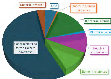
Fig. 6- Grafico a torta della composizione litologica della facciata Sud-Est (elaborazione grafica degli autori, 2025)
