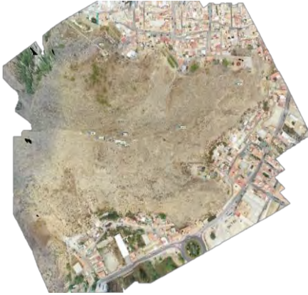
Fig. 12- Vista de la ortoimagen general obtenida en el proceso fotogramétrico con Metashape Profesional de Agisoft (Autores)
