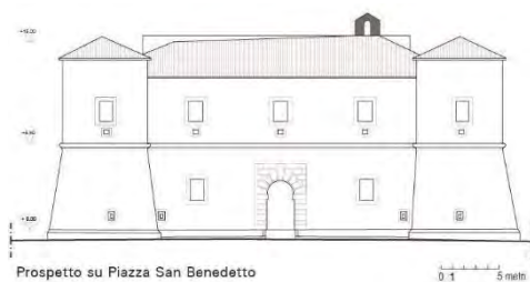
Fig. 9- Rilievo architettonico della Castellina a Norcia, prospetto su piazza San Benedetto (elaborazione grafica di Serena Pallotti, 2025)
