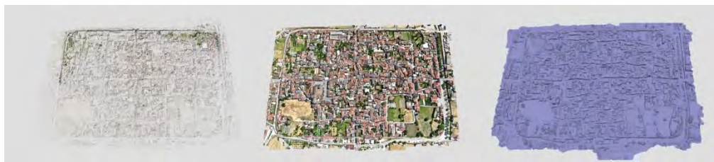
Fig. 6- Elaborazione fotogrammetrica in Agisoft Metashape: nuvola sparsa, nuvola densa e modello mesh della città murata di Alife (elaborazioni e restituzione grafica di Angelo De Cicco)
