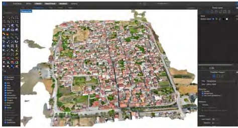
Fig. 8- Modello mesh generato in Agisoft Metashape e importato su Rhinoceros (elaborazioni e restituzione grafica di Angelo De Cicco)
