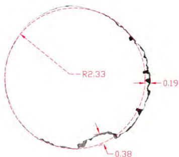
Fig. 8- Sección en planta de torre. Se comprueba la deformación excentrica hacia el este y la perdida de material del muro
