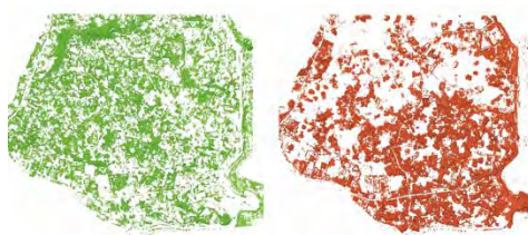
Fig. 5- Classificazione della nuvola di punti densa, vegetazione e edificato (Patryk Rynkowski, 2024)
