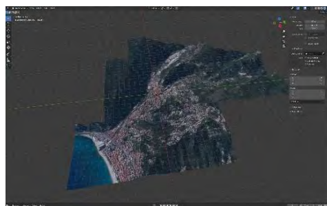
Fig. 6- Importazione di dati Google 3D tiles in Blender per contestualizzare il modello (elaborazione grafica di FABRICA Società Cooperativa, 2025)
