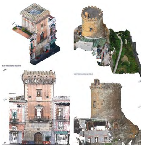
Fig. 11- Torri di Forio d'Ischia, nuvola densa, prospetto. Da sx: Torre Quattrocchi, Torone, Torre Nacera, (Patrik Rynkowski, 2024)
