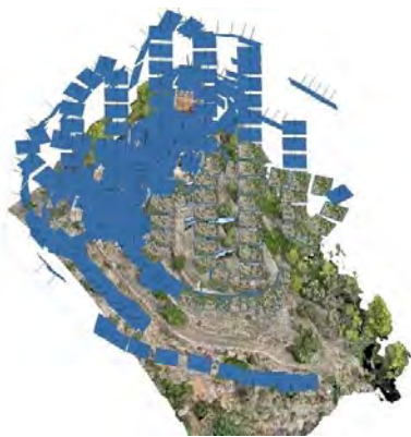
Fig. 6- Proceso de restitución fotogramétrica. Alineación de imágenes (elaboración gráfica por Ana Pérez-Vila, Teresa Gil-Piqueras & Pablo Rodríguez-Navarro, 2025)
