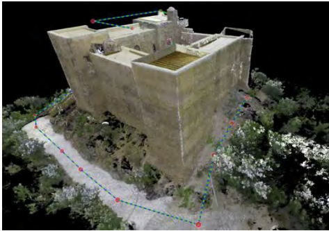
Fig. 13- Vista global de la nube completa obtenida con TLS (RTC360 de Leica) (Autores)
