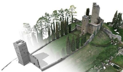
Fig. 8- Confronto tra il modello HBIM (sinistra) e la nuvola di punti (destra) usata come base per la modellazione (Fantoni, 2025)
