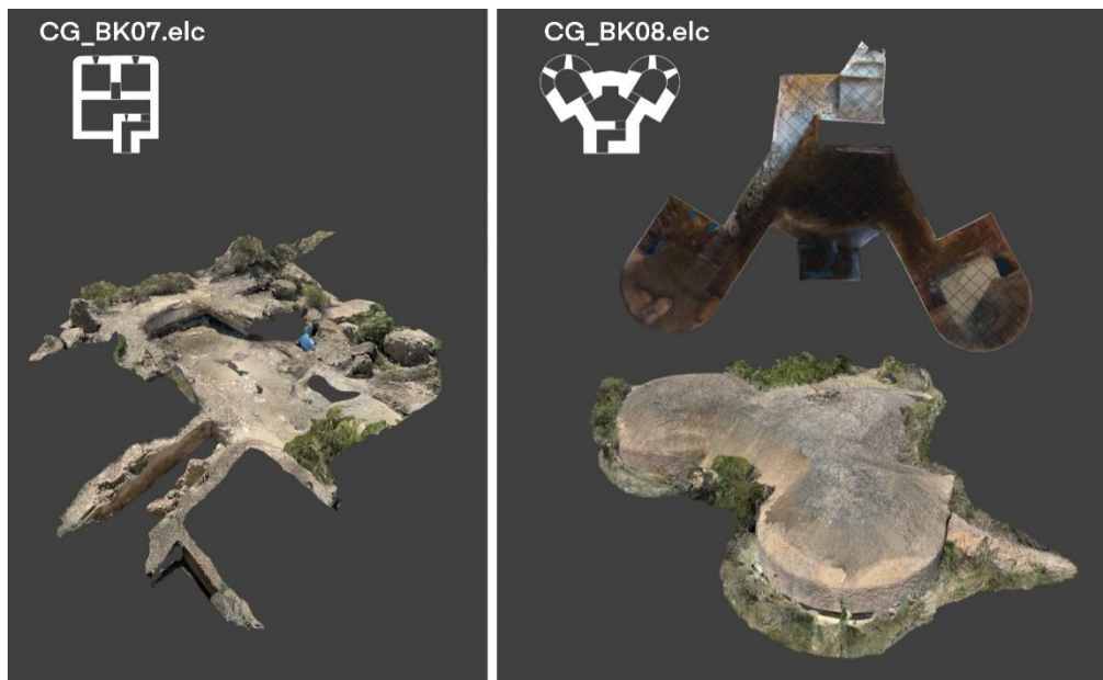
Fig. 6- Levantamientos fotogramétricos de los búnkeres BK07.elc y BK08.elc. El BK07 (izq.) es un búnker de planta cuadrada con cuatro compartimentos orientado hacia el sur de la nacional; su estado de conservación en ruinas requiere de una campaña arqueológica. El BK08 (dch.), al que se accede a pie llano por la parte posterior, está compuesto por un búnker de dos senos dispuestos radialmente, equipados cada uno con mesa para ametralladora, barriendo ambos más de 180° del campo de tiro (fuente: G. Sanna)
