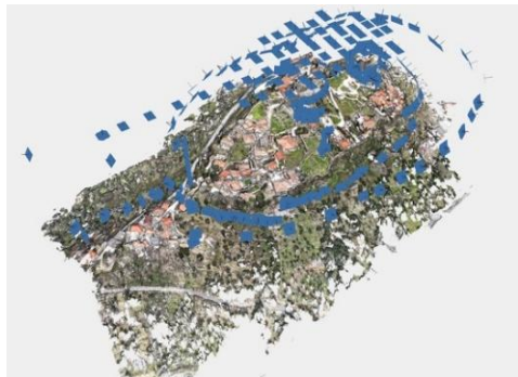
Fig. 5- Nuvola di punti densa con camere (elaborazioni e restituzione grafica di Angelo De Cicco)
