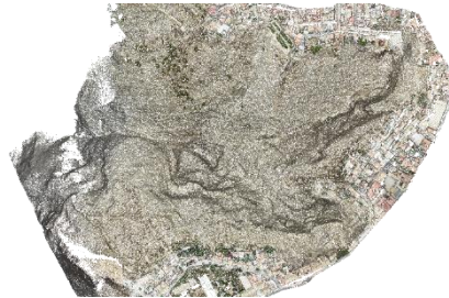
Fig. 9- Vista de la nube densa generada en el proceso fotogramétrico con Metashape Profesional de Agisoft (Autores)
