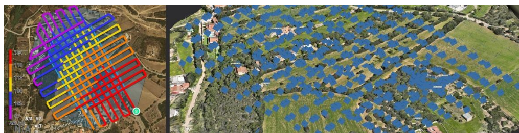
Fig. 6- Piano di volo UAS e punti di presa degli scatti (elaborazioni grafiche di N. Paba)
