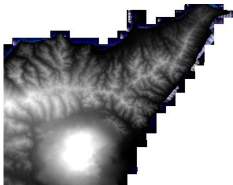
Fig. 7- Immagine da Modello Digitale del Terreno (MDT/DEM) con passo di 2 metri da dati LIDAR del volo ATA 2012–2013 (Geoportale della Regione Siciliana – S.I.T.R.)
