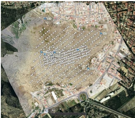
Fig. 8- Vista aérea de la localización de los puntos medidos con GNSS y el posicionamiento de las capturas realizadas con el UAV (Autores)
