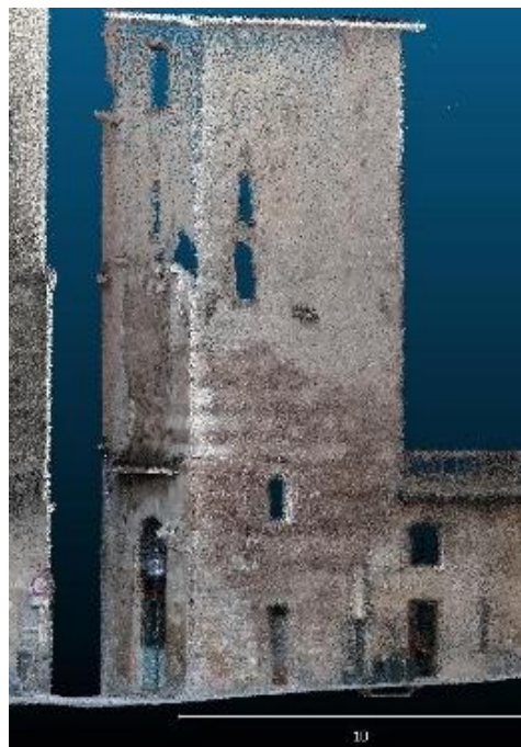
Fig. 3- Nuvola di punti texturizzata della torre oggetto di studio (elaborazione grafica degli autori, 2025)
