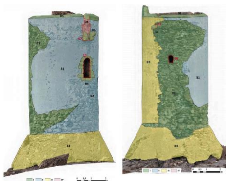
Fig. 11- Análisis paramental. Las UEs marcan la secuencia constructiva de la torre
