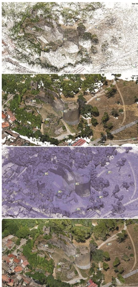
Fig. 9- Dall'alto verso il basso: nuvola di punti sparsa; nuvola di punti densa; modello mesh; modello mesh texturizzato (elaborazione grafica di Domenico Iovane & Rosina Iaderosa, luglio 2025)
