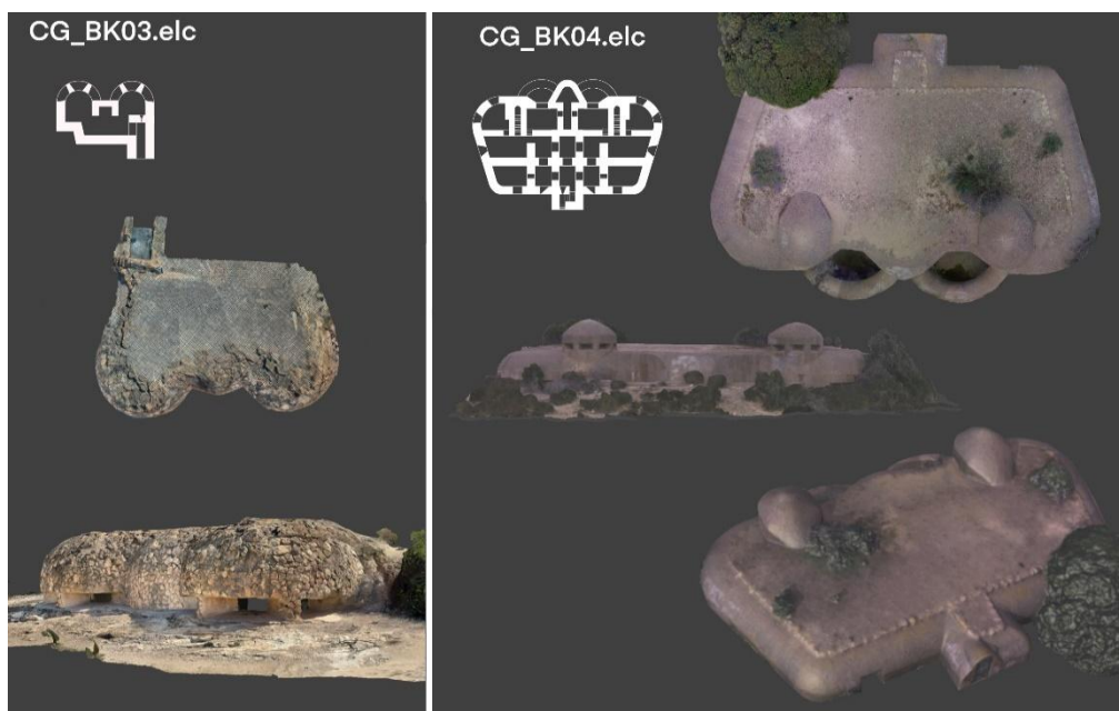
Fig. 4- Levantamientos fotogramétricos de los búnkeres BK03.elc y BK04.elc, ambos de dos senos cada uno. El BK03 (izq.) está compuesto por un búnker de dos senos al que se accede por una puerta posterior, equipados cada uno con mesa para ametralladora, barriendo ambos 180° (Fuente: G. Sanna, 2025). El BK04 (dch.) es el mayor del enclave, consta de dos plantas, presenta aspilleras en sus cuatro frentes y dos senos descubiertos que actúan de trinchera de protección del búnker (fuente: R. Souza Moraes, 2019)
