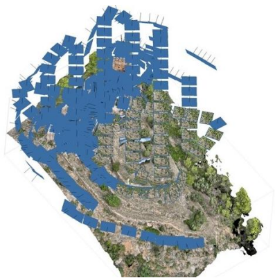
Fig. 6- Proceso de restitución fotogramétrica. Alineación de imágenes (elaboración gráfica por Ana Pérez-Vila, Teresa Gil-Piqueras & Pablo Rodríguez-Navarro, 2025)
