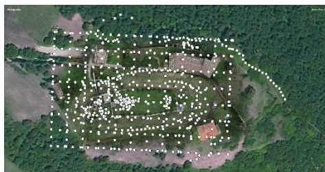
Fig. 5- Schermata di Agisoft Metashape con indicazione dei punti di ripresa tramite drone (Fantoni, 2025)
