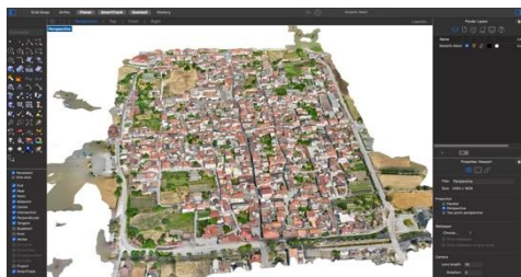
Fig. 8- Modello mesh generato in Agisoft Metashape e importato su Rhinoceros (elaborazioni e restituzione grafica di Angelo De Cicco)
