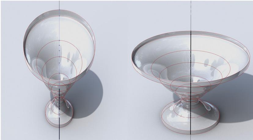
**Fig. 4.** Confronto tra la vera forma dell'anamorfosi del rinfrescatoio (a sinistra) con indicati in rosso i cerchi dei paralleli e l'immagine osservata dalla posizione di veduta vincolata (a destra) (elaborazione grafica di L. Baglioni).
