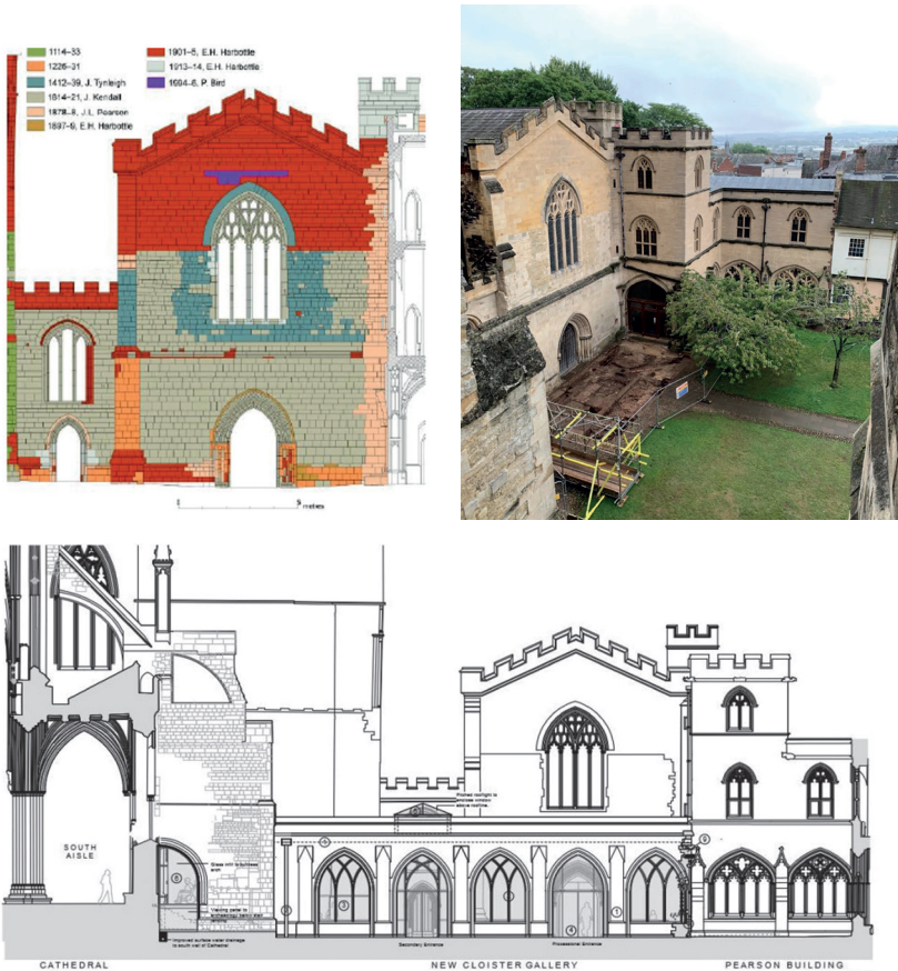
Fig. 6. Proposal for a new cloister gallery for the Exeter Cathedral: drawings presented in January 2022 to the casework committee for comments. Initial architectural thoughts for a new portico were discussed together with materials used, reversibility of connection, modern and traditional approach, reversibility of new elements within the historic structure. Comments were made by expert members of the committee, which will respond with a letter to the project architect or the council conservation officer responsible for the project planning and listed building approval / Proposta progettuale per la realizzazione di un nuovo portico nel chiostro della Cattedrale di Exeter presentata alla commissione per il restauro nel gennaio del 2022. Le prime idee progettuali sono state elaborate considerando la scelta dei materiali, la reversibilità dell'intervento, il linguaggio moderno e tradizionale impiegato, la reversibilità dei nuovi elementi nel contesto della struttura storica. I membri del comitato hanno espresso alcune opinioni e risponderanno con una lettera ufficiale all'architetto, autore del progetto, o al responsabile della conservazione all'interno della Commissione responsabile per la pianificazione e approvazione dei progetti su edifici storici. (© Acanthus Clews Architects) [ https://www.spab.org.uk/news/casework-exeter-cathedral ]
